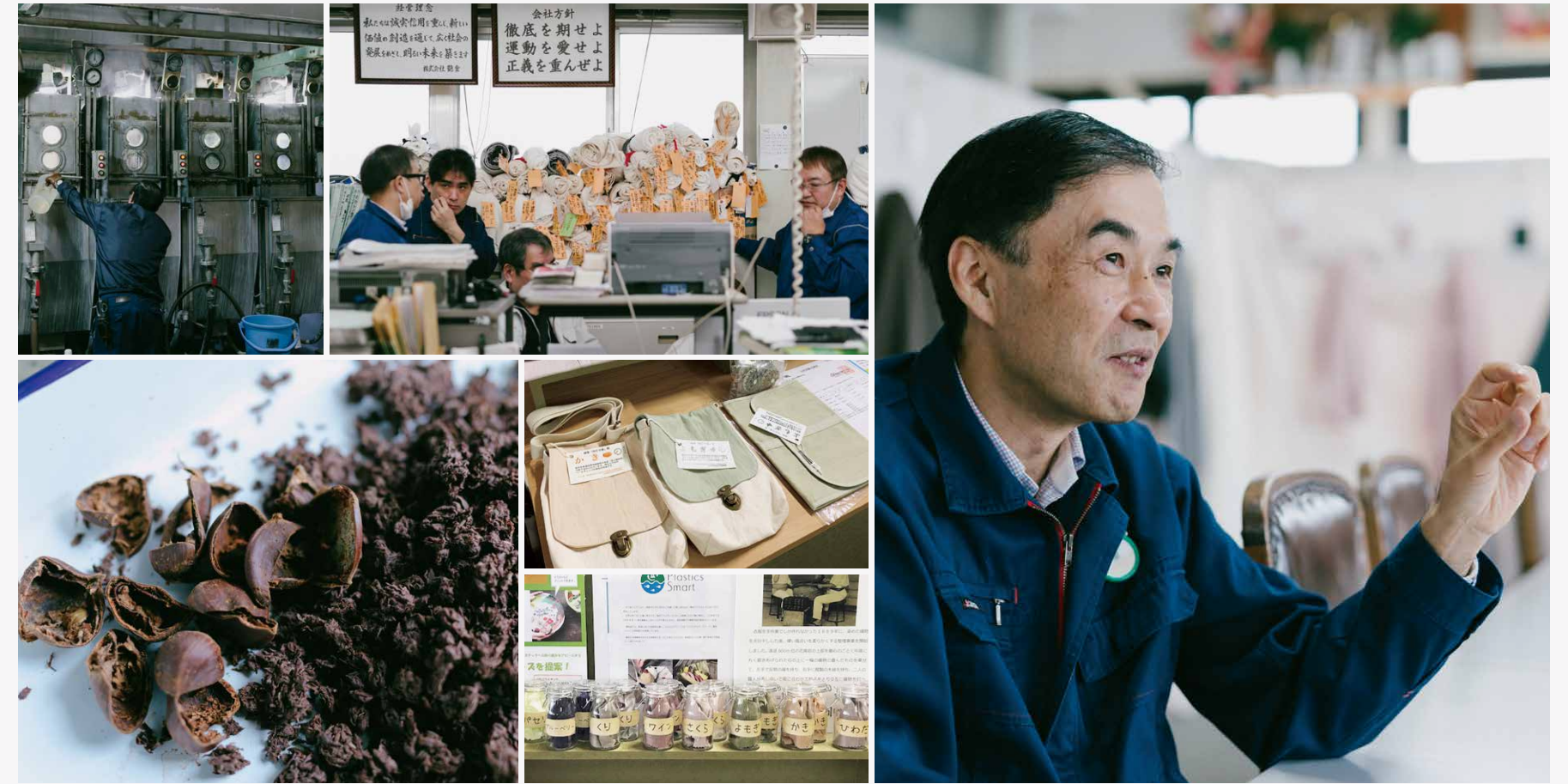
[写真:上段左]約1万坪の土地に4棟の建屋からなる大垣工場。主建屋は6,434㎡と広大で「ここは湿度がすごい」「ここは独特においなど、歩くごとに状況が変わっていく。この染色機が並ぶエリアは、ボイラーの熱と蒸気で冬でも暑さを覚えるほど。[上段右]おびただしい量のサンプルのストック。艶金の仕事量とその幅広さを無言で訴える。[下段左]のこり染めに用いる栗皮とコーヒーの殻が、[中段右]やさしい色合いのポーチ。染料は柿(左)とよもぎ(中央と右)。[下段右]様々な原料からのこり染めを施した色のサンプル。
