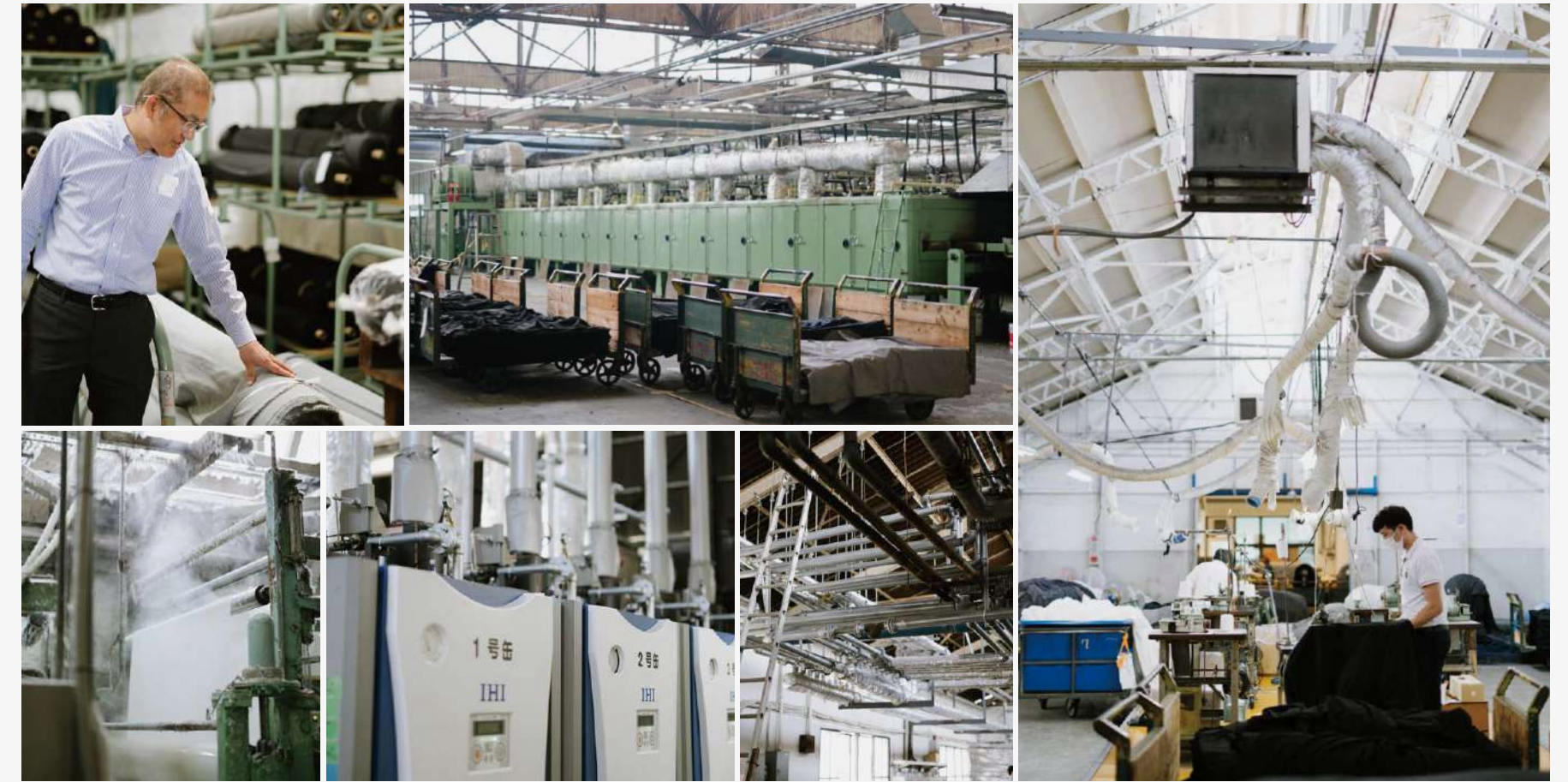
[写真:上段左]生地に触れ、風合いを確認する大島社長。聞くと「もう、無意識に触っちゃう」のだと言う。[上段中]国内初導入! 省エネ大賞を引き寄せたといっても過言ではない、熱回収式ヒートセット機。[下段左]生地を洗浄する精練機。染色機から発生する約50°Cの冷却排水を再利用している。この排熱回収の仕組みは、他の設備へも応用可能。今も試行錯誤が続く。[下段左から2枚目]55年使ってきたC重油のボイラから、都市ガスの貫流ボイラに更新。CO2排出量は3分の2へ、「コストダウンにはつながっていない」と大島社長は苦笑するが、地球にはきわめてやさしい。[下段左から3枚目]頭上に張り巡らされた配管。実はここで、未利用熱を回収・再利用する仕組みが構築されている。配管の一部には銀色の断熱材。少しも熱損失を抑えようという強い意思がうかがえる。高岡製糸場と同様の屋根構造。上方にある左右の窓が熱気を効率的に逃がし、自然光をふんだんに取り込む。時代を超えた省エネ建築だ。ここに限らず、工場全体が明るく、日中はほとんど照明不要だという。
