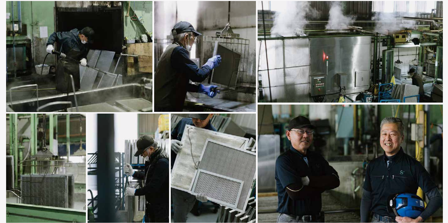
[写真:上段左]回収したグリスフィルターの最初の工程は、高圧洗浄機による洗浄。自立油汚れは粗方この段階で落とすことができる。[上段中]次にリフトで流れる洗浄機へ、人の手でセットしていく。[上段右]薬剤での洗いを2度繰り返して行く。「ボイラーの熱と高い湿度により、夏場はサウナです(笑)」と草深工場長。[下段左]最後のすすぎが終わると、まるで新品のようにピカピカのフィルターが顔を出す。[下段左から2枚目]必要に応じてメンテナンスも行う。顧客は安心して、キレイで万全の状態のフィルターを使うことができる。[下段左から3枚目]「今後は設備・技術・営業経験を活かして、フィルターに留まらずさまざまなものの洗浄・メンテナンス事業をして提供していきます」と草深工場長。2018年に設立した新工場も活用し、事業拡大を視野に入れている。[下段右]30年、仲間とともにその中心となって二人三脚で歩んできたふたり。「絆」というのは浅はかな表現かもしれないが、それは目に見えるものだということを実感した。
