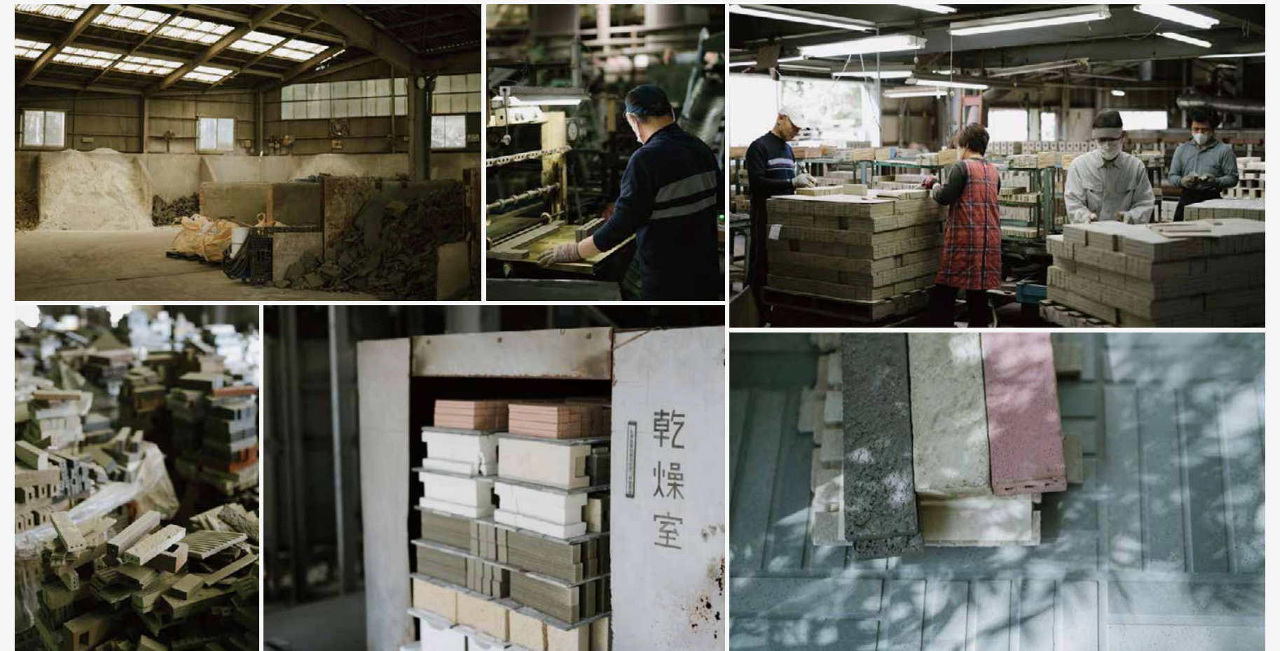
[写真:上段左]自然光が適度に入る庫内。さまざまな土たちが出荷を待っている。[上段中央]目的に沿って最適な配合になった土が水と混ぜられ、練られ成形されていく。当然まだ柔らかいゆえ、作業にも慎重さが求められる。[上段右]熟練の職人たちが、一枚一枚検品を行う。『カンカンコンコン…。』トンカチでタイルをたたく音は規則的で、ときおりリズムのように聞こえる。[下段左]積み上げられた試作品の残骸。大都市のジオラマのようでも不思議とずっと眺めていられる。なぜだろう?と考えたが、「一枚一枚のディテールが美しいからだ」と、あとで納得した。[下段中央]乾燥室(のごく一部)。どんな素材でどんな成形・表情づけ・焼成をするかで、乾燥の時間も大きく異なる。蓄積されたデータは膨大だ。
