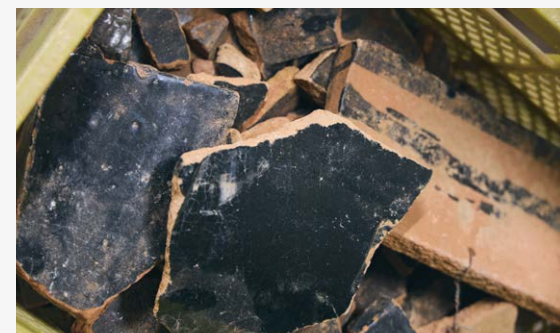
被災地から持ち帰った能登瓦。これを粉砕し、原料に再利用する。
